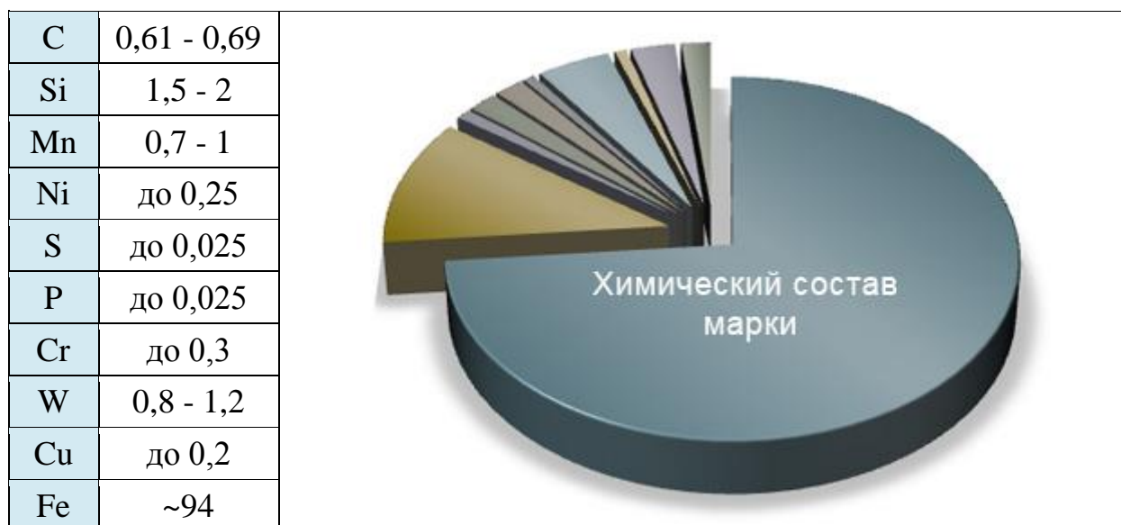
Химический состав в % стали 65С2ВА, [4]
