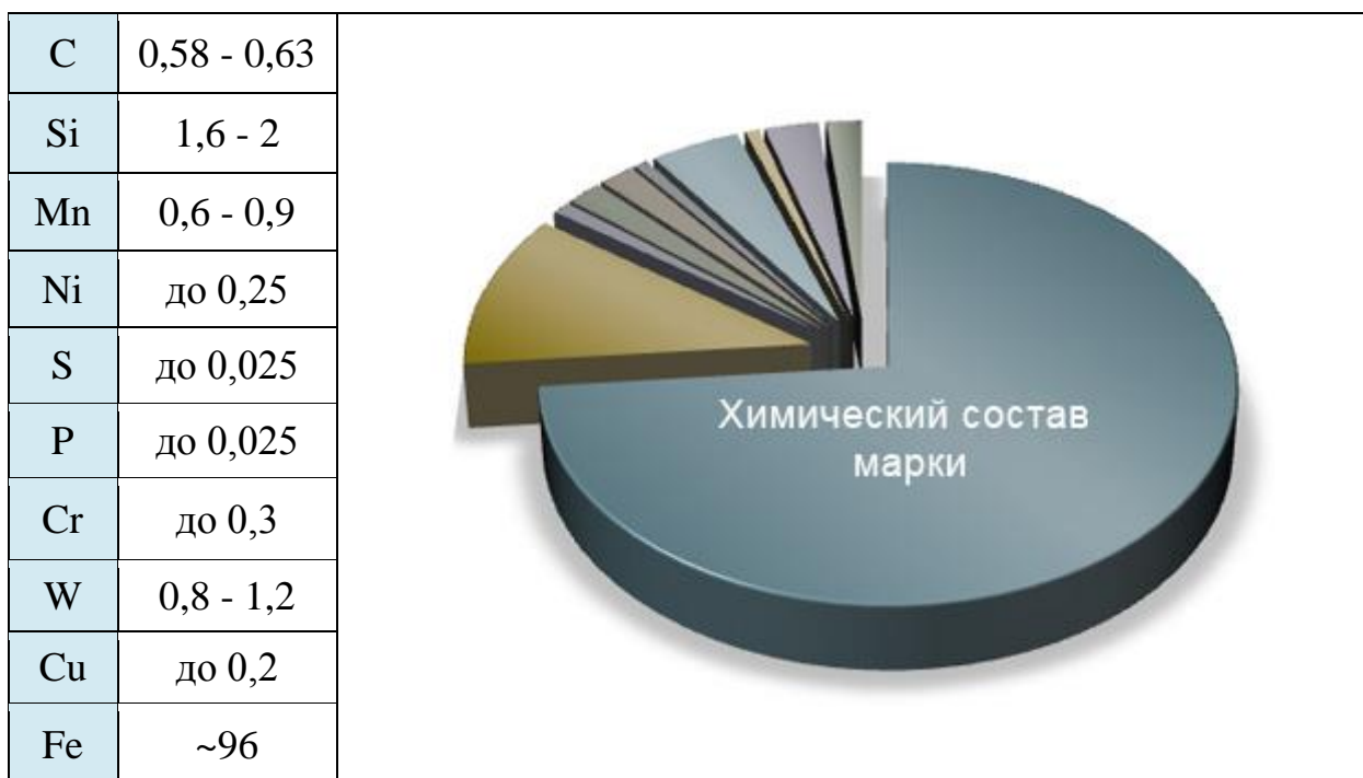
Химический состав в % стали 60С2ВА, [4]
