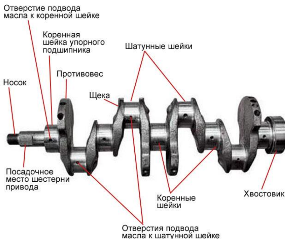
Рисунок 2 – Конструкция полноопорного коленчатого вала
